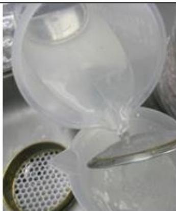
4. 回収プロセスの最後に、繊維が残留したストレーナーをすすぎます。
