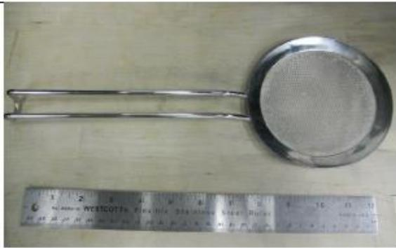
1. 試料の繊維採取に使用するストレーナーの例。
