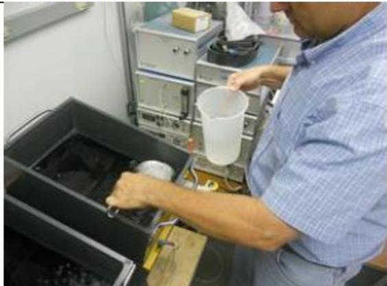
2. ストレーナーを使用してボックスから試料／繊維を回収します。
